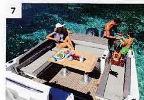
6/7 Die achtere Plicht ist geräumig, die Sitzgruppe kann zur Sonnenliege umgebaut werden. Die ausklappbare Schanz ist ein neues Feature der Serie 2.
